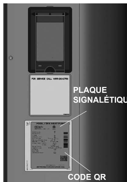
Figure 1. Numéro de modèle et numéro de série N° d'enregistrement de la garantie:
